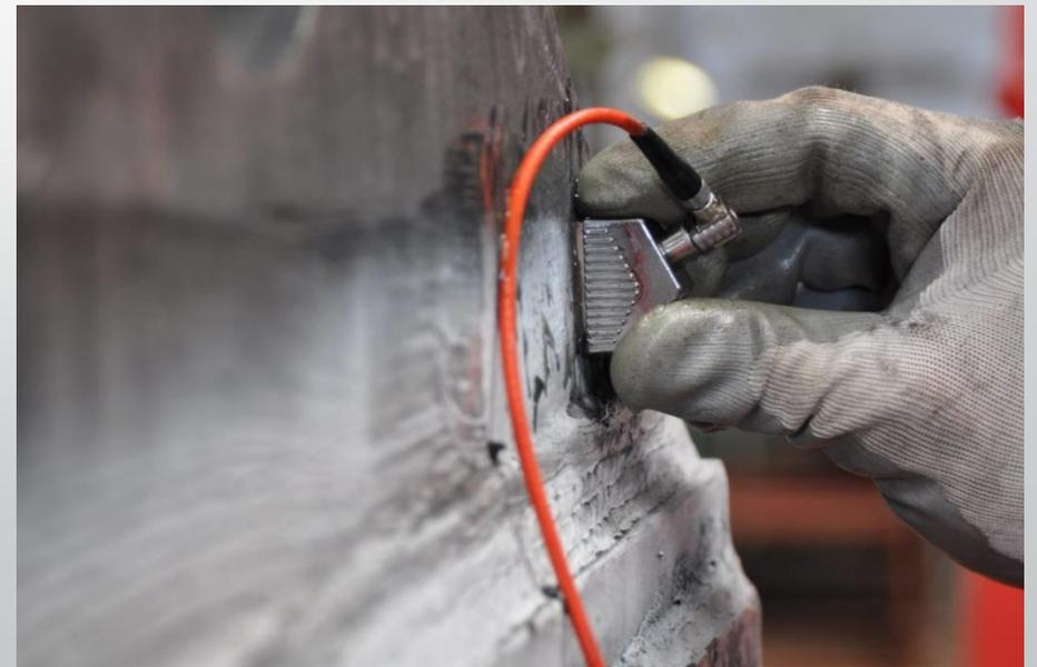
Используем методы неразрушающего контроля, такие как: ультразвуковая дефектоскопия, толщинометрия, капиллярный, визуальный и измерительный методы.
