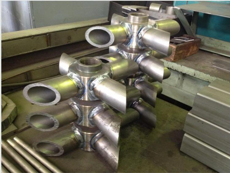
Турбинная мешалка реактора
